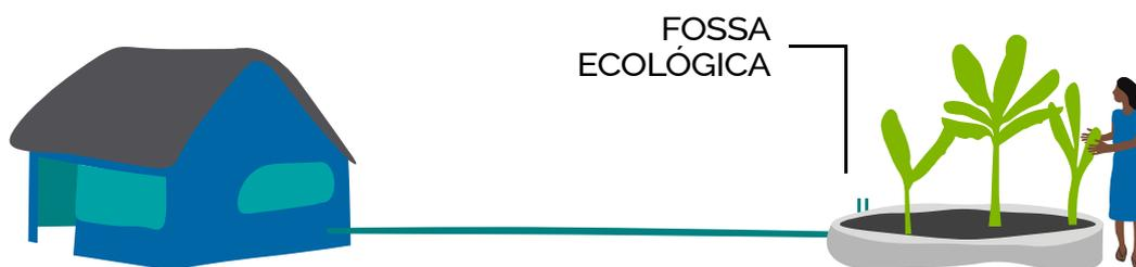
Com o aumento do volume de esgoto na fossa ecológica, o conteúdo preenche também as camadas superiores, de brita e areia, onde ocorre a filtração, até atingir a camada de solo. Durante esse trajeto, o efluente é mineralizado e filtrado. As raízes das plantas localizadas nas camadas superiores se desenvolvem em busca de água e dos nutrientes disponibilizados pela decomposição da matéria orgânica.
